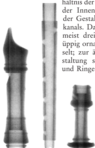
Abb. 1: Röntgenaufnahme einer Sopranblockflöte von Abraham van Aardenberg
